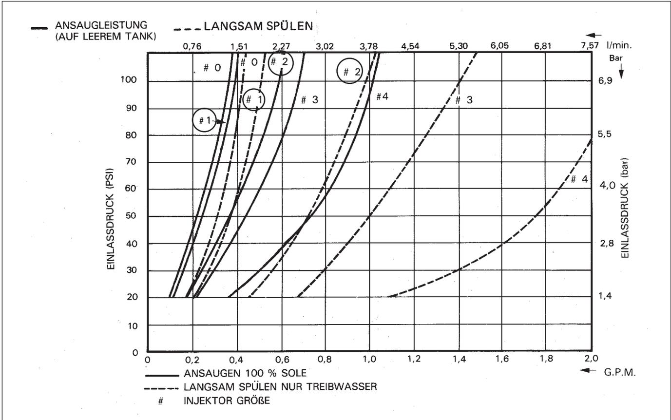
**Injektorleistung in Abhängigkeit vom Rohwasserdruck**
