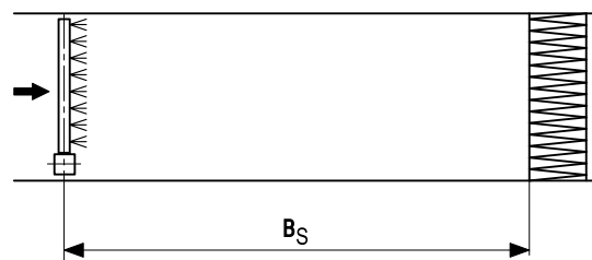
Obr. 33: Montáž ve vzduchovodu následující překážky: HEPA filtr
